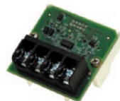
图6：负载电流卡（配件23GA/GB）
